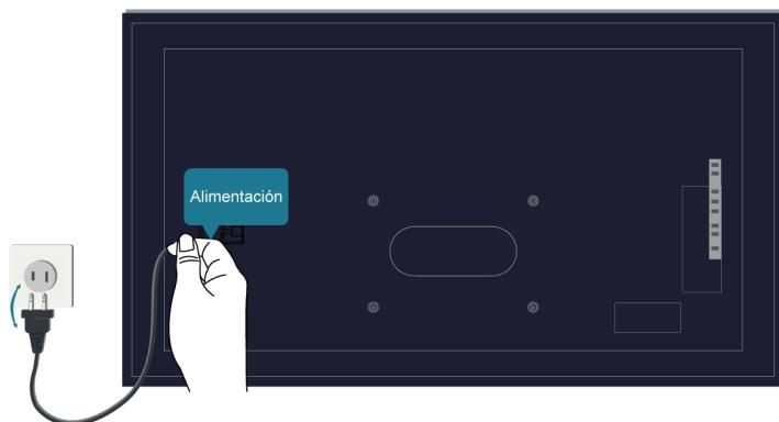
Si la señal es intermitente, desenchufe el cable de alimentación del TV del tomacorriente de CA y vuelva a enchufarlo después de 60 segundos.
