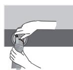
c. Introduzca la tubería de drenaje en la salida de drainage, y la altura A debe ser inferior a 90 cm.
