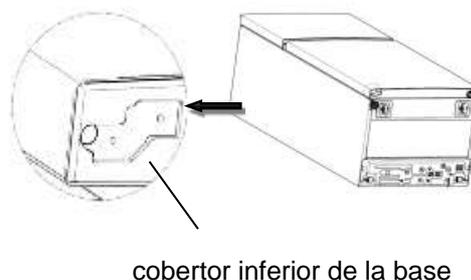
2. Coloque el tornillo en el orificio de la almohadilla protectora de caucho.
