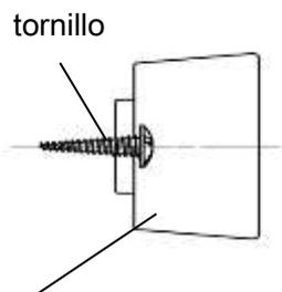
3. Alinee el tornillo con el orificio del cobertor inferior de la base. Coloque firmemente la almohadilla protectora de caucho en el cobertor de la base utilizando un destornillador (autosuministrado).
