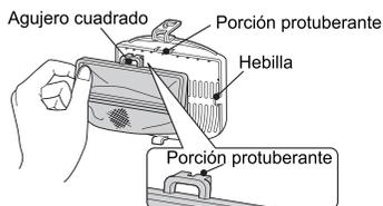
5. Reinstale la cubier ◆ Se puede reemplazar el filtro una vez que se desgaste.
