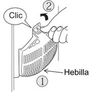
Presione la red en la protuberancia de la carcasa del orificio cuadrado y luego nivele las hebillas de la izquierda y derecha.
