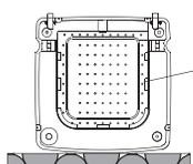
Orificios de ventilación en la parte inferior
