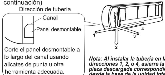
Corte el panel desmontable a lo largo del canal usando alicates de punta u otra herramienta adecuada.
